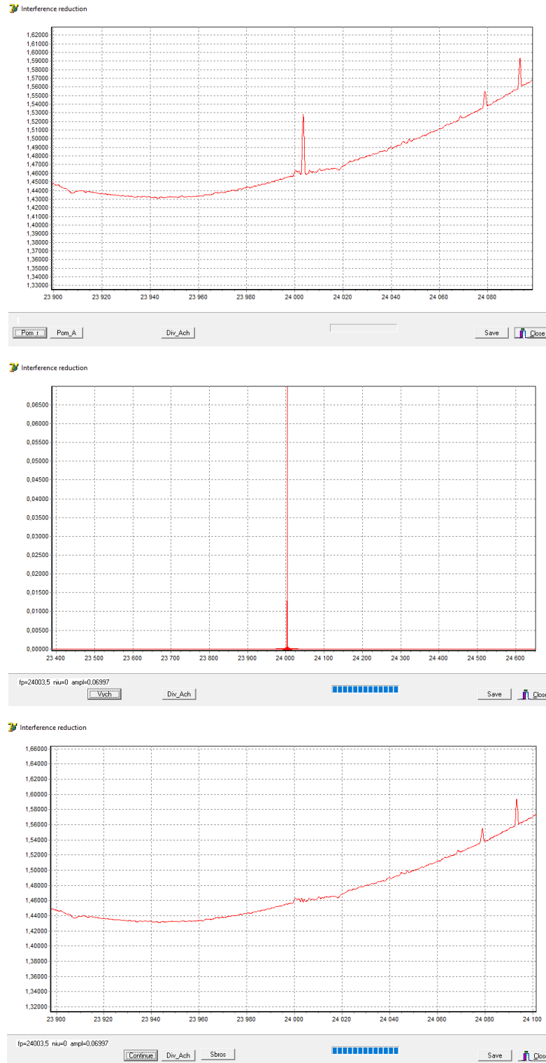
Рис. 2.10. Видалення вузькосмугової завади в усередненому спектрі АКФ. Зверху – зумована частина спектру, що містить вузькосмугову заваду близько частоти 24 МГц; Всередині – модель завади з відповідною амплітудою та шириною; Знизу – зумована частина спектру після видалення завади близько частоти 24 МГц.
