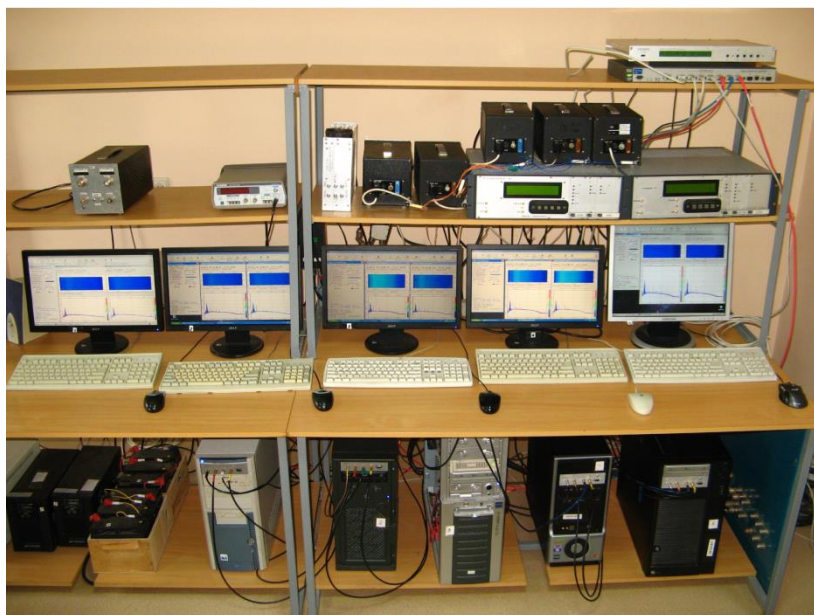
Рис. 2.5. П'ять цифрових спектроаналізаторів DSP-Z, встановлених на УТР-2. Рисунок взятий з роботи [111].
